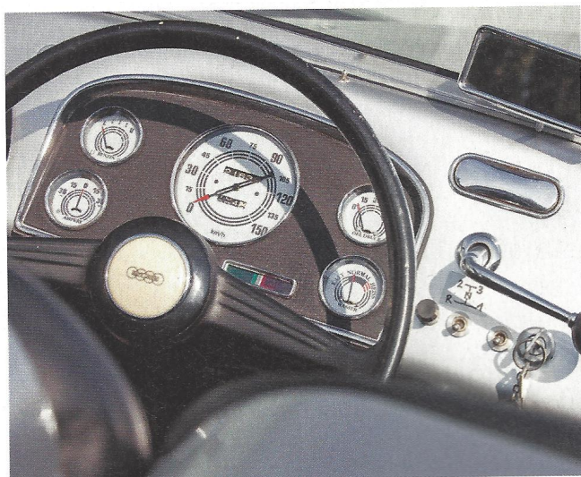
Die umfangreiche Instrumentierung erstrahlt wieder im Neuzustand. Der Rückspiegel wanderte von der Windschutzscheibe auf das Armaturenbrett.
